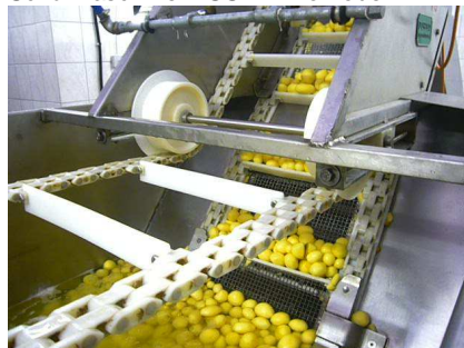
8 • Vorratsbehälter hinter MSS-Maschine. Funktionen: Lagern, Waschen, Dosieren.
