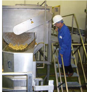
11 • Kartoffelschälung mit der Rollenschälmaschine R-3012-100KK-S130. Schnecken-Ø 1300, Rollenlänge 3000 mm.
