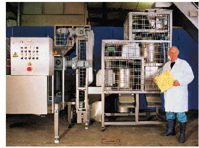
15 • Die Anlage ist lieferbar als Zwiebelschälanlage und/oder als Kartoffelschälanlage mit Karborund-Messer-Schälung. Auch lieferbar umbaubar zu einer Kartoffel-Schälanlage.
