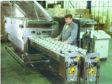
1 • Maschine MSS-BM mit zwei Messer-Schälstrecken, aus der Schälmaschine herausgefahren.
