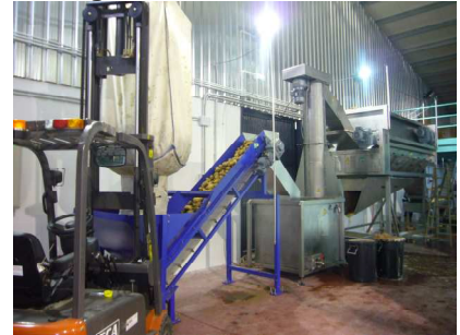
12 • Blick in einen Kartoffelschälbetrieb: Rohware in „big bags“, Dosieranlage, Steinfänger, Rollenschälmaschine.
