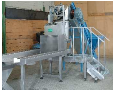
14 • Kleinere Kartoffelschälanlage, automatisch arbeitend; schnell umbaubar zu einer Zwiebelschälanlage.
