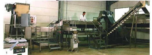
15 • Die Anlage ist lieferbar als Zwiebelschälanlage und/oder als Kartoffelschälanlage mit Karborund-Messer-Schälung. Auch lieferbar umbaubar zu einer Kartoffel-Schälanlage.
