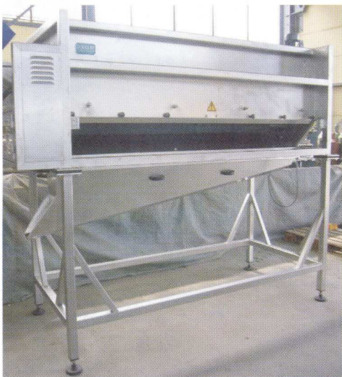
2. Najmenšia valcová lúpačka DORNOW R-OW- 500-B je vybavená 4 valcami o priemere 150 mm s dĺžkou valcov 4.000 mm. Priemer dopravného šneku je 500 mm.
