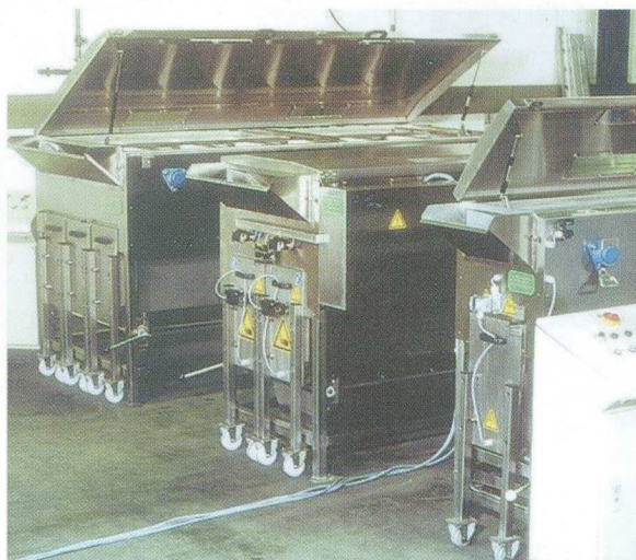
8. Lúpačka MSS sa vyrába v troch veľkostiach: MSS-A s jednou, MSS-B s dvoma a MSS-C s tromi lúpacími dráhami. Lúpačka môže byť vybavená nožovými, cibulovými, karborundovými a špeciálnymi lúpacími kotúčmi.
