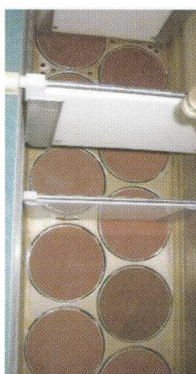
Lúpacia linka MSS s karborundovými kotúčmi.
