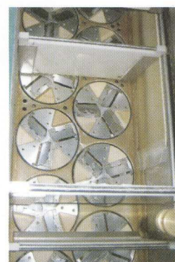
Lúpacia linka MSS s nožovými kotúčmi.
