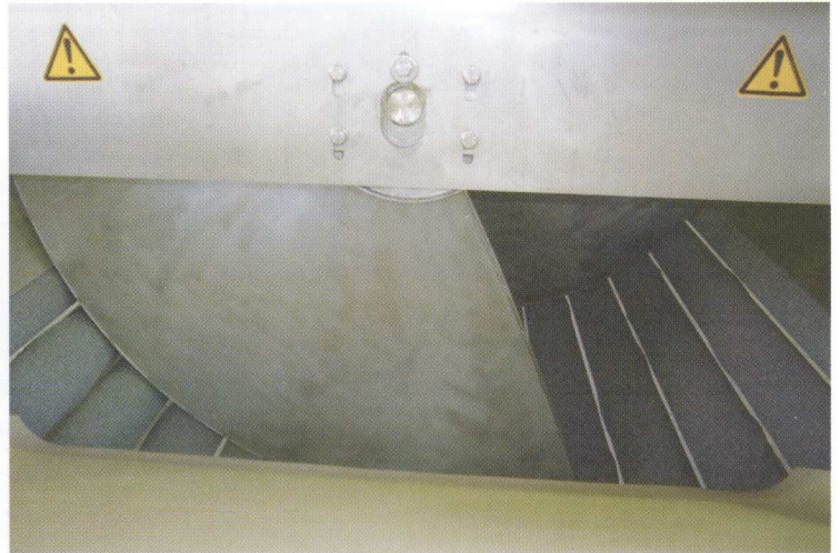
1. Lúpačka s lúpacími valcami DORNOW R-OW-190-A1 v prevádzke na spracovávanie zemiakov. Priemer dopravného šneku je 1.900 mm, stroj je vybavený 14 lúpacími valcami o priemere 150 mm s dĺžkou valcov 4.000 mm. Zariadenie je vhodné pre nasadenie vo veľkých prevádzkach.
