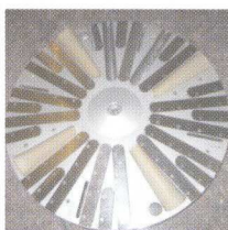
Pohľad do lúpačky s lúpacími valcami, typ R-OW 190-A1, ktorá je vybavená 14 karborundovými valcami o priemere 150 mm, dĺžka valcov je 4.000 mm. Priemer dopravného šneku je 1.900 mm.
