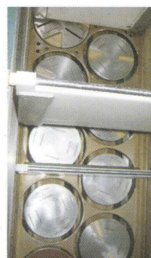
Lúpacia linka MSS s cibulovými kotúčmi.
