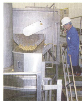
7. Loupačka DORNOW s loupacími válci DORNOW R-OW- 130-A na zpracovávání brambor v provozu.
