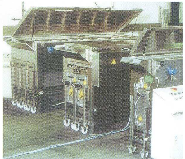
8. Loupačka MSS se vyrábí ve třech velikostech: MSS-A s jednou, MSS-B se dvěma a MSS-C s třemi loupacími dráhami. Loupačka může být vybavena nožovými, cibulovými, karborundovými a speciálními loupacími kotouči.
