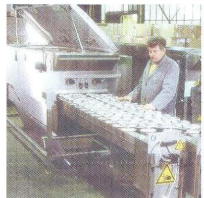
11. Výměna nožových, karborundových a cibulových loupacích kotoučů je možná v průběhu několika sekund.
