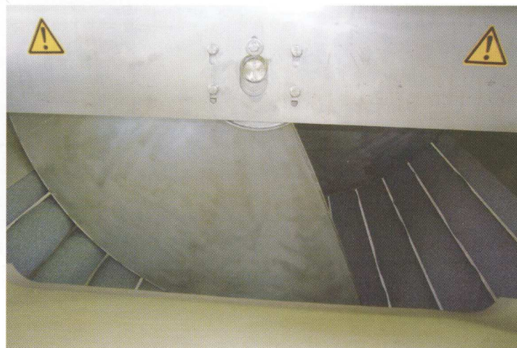
1. Loupačka s loupacími válci DORNOW R-OW-190-A1 na zpracovávání brambor v provozu. Průměr dopravního šneku je 1.900 mm, stroj je vybaven 14 loupacími válci o průměru 150 mm, s délkou válců 4.000 mm. Zařízení je vhodné pro použití ve velkých provozech.
