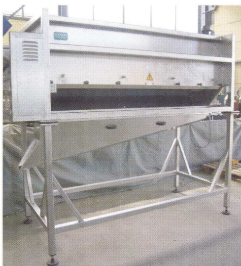
2. Nejmenší válcová loupáčka DORNOW R-OW- 500-B je vybavena 4 válci o průměru 150 mm, s délkou válců 4.000 mm. Průměr dopravního šneku je 500 mm.
