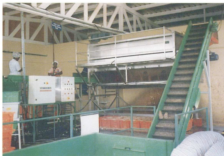
3. Válcová loupáčka DORNOW na loupání manioku v africkém provozu (R-OW- 110-A).
