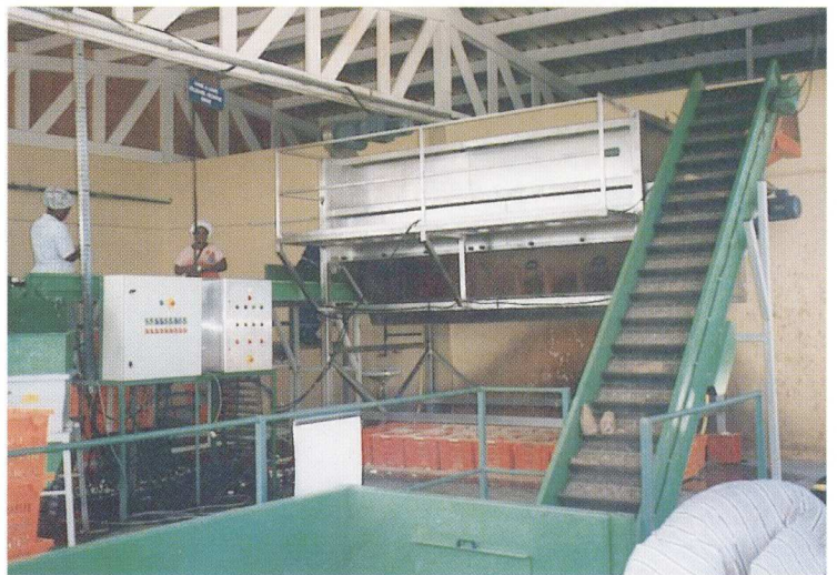
3. Egy afrikai üzemben DORNOW a maniőka hámozására használt hámozó - hengeres berendezés. (R-OW-110-A).
