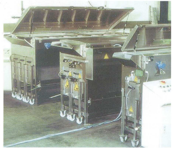
8.A hámozó - korongos berendezéseket három nagyságban gyártják: MSS-A amely egy, MSS-B kettő, a MSS-C pedig három hámozó vonallal van felszerelve. A berendezéseket karborundum-, hagymahámozó-, kés- és speciális hámozó korongokkal lehet ellátni.
