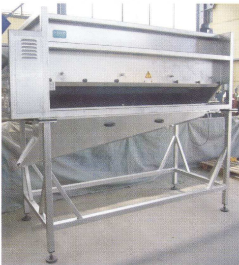
2. DORNOW R-OW-500-B a sorozat legkisebb típusú hámozó - hengeres berendezése. A négy hámozó - henger átmérője 150 mm a hossza 4.000 mm. A csigaszállító átmérője 500 mm.
