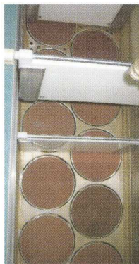
Az MSS hámozó - korongos berendezés karborundum korongokkal.
