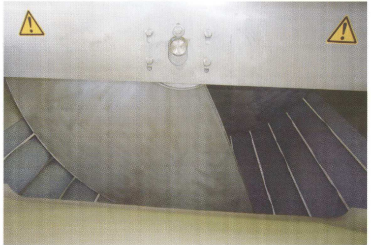
1. DORNOW R-OW-190-A1 típusú hámozó - hengeres berendezés egy burgonya feldolgozó üzemben. A 14 hámozó - henger átmérője 150 mm, hossza 4.000 mm. A csigaszállító átmérője 1.900 mm. A berendezés nagy üzemek részére alkalmas.
