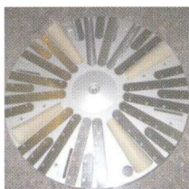
Egy R-OW 190-A1 típusú hámozó - hengeres berendezés belső nézete. A berendezés 14 karborundum bevonatú hengerrel működik. Egy henger átmérője 150 mm, hossza 4.000 mm. A csigaszállító átmérője 1.900 mm.
